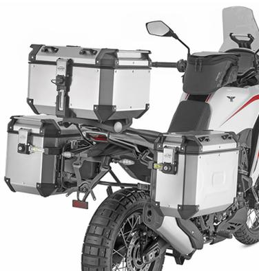
**KLO9352CAM** Portavaligie laterale specifico KL ONE-FIT configurato per valigie MONOKEY® CAM-SIDE
