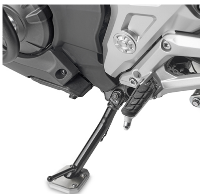
ES1192K Supporto specifico in alluminio e acciaio inox, per allargare la superficie di appoggio del cavalletto laterale originale
