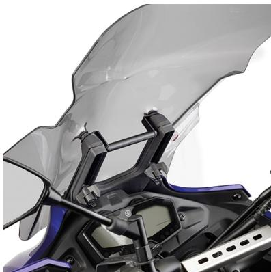
**KFB2130****Chassis support GPS à monter derrière la bulle, pour fixer KS920M, KS920L, KS95KIT et les support GPS - Smartphone**
