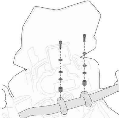
**03SKITK****Kit de fixation spécifique pour Smart Bar KS900A**
