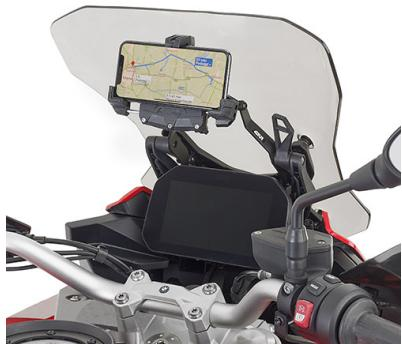
**KFB5137****Chassis support GPS à monter derrière la bulle, pour fixer KS920M, KS920L, KS95KIT et les supports GPS - Smartphone**
