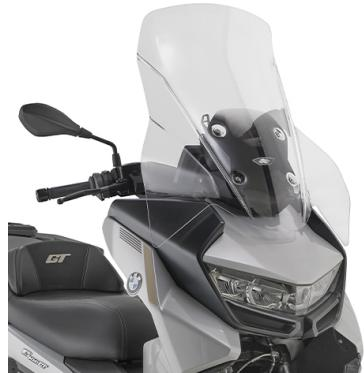
8 cm plus haute que celle d'origine / se monte sur les points de fixation du pare-brise d'origine
