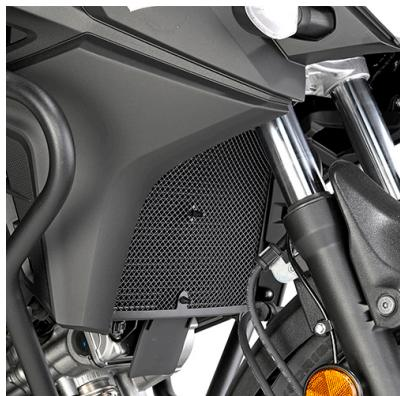
**KPR3112****Protector radiador específico en acero inoxidable acabado negro**
