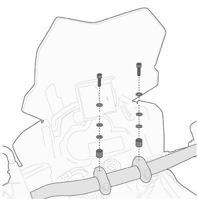
**02SKITK****Kit específico para el montaje del Smart Bar KS900A**
