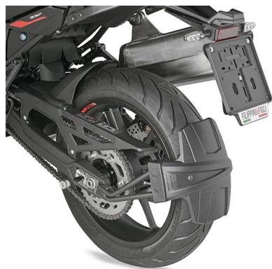
**RM8717KITK** Kit específico para el montaje del salpicadera posterior KRM02
