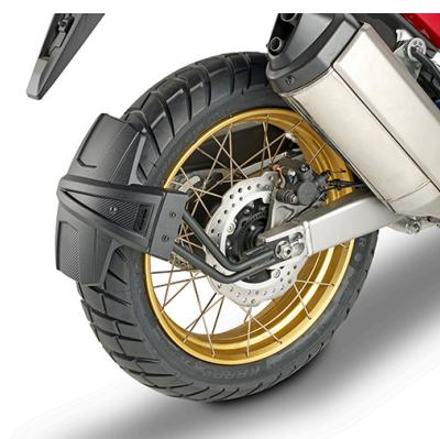
**RM1178KITK****Kit específico para el montaje del salpicadera posterior KRM02****EH1178K****Extensión en ABS negro, para paramanos originales**
