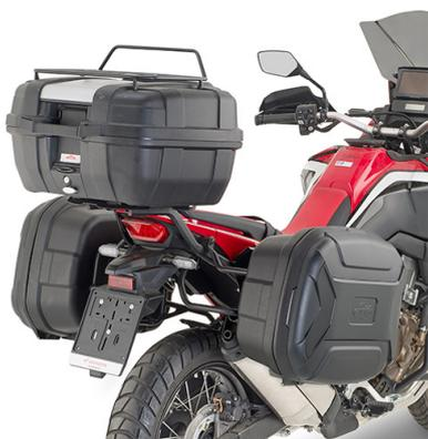
**KLO1179MK** Portamaletas lateral específico KL ONE-FIT configurado para maletas MONOKEY®
