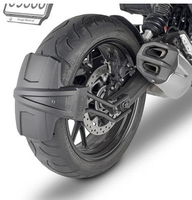
**RM5137KITK****Kit específico para el montaje del salpicadero posterior KRM02**
