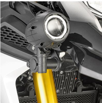
**LS5126K** Spezifisches Montagekit für Zusätzliche ohne Spezifischer Sturzbügel
